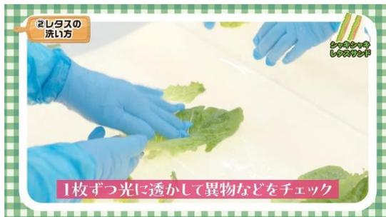
1枚ずつ光に透かして異物などをチェック。自動洗浄機で「洗浄」→「殺菌」→「すすぎ」を行います。
